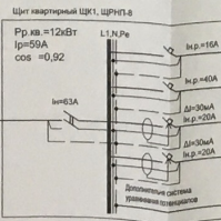
Схема электрическая однолинейная электропитания квартиры
